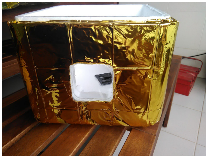
Il·lustració 35: Caixa de porexpan un cop recoberta amb l'aïllant tèrmic utilitzant cola blanca. (Elaboració pròpia).
