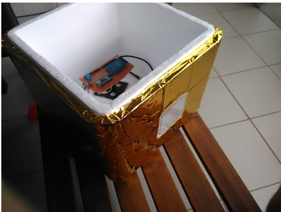
Il·lustració 58: Resultat final de la construcció de la sonda, tot i que hi manca el rastrejador GPS TK-102, les Bateria de mòbil externes, l'aïllant de l'interior i la càmera de telèfon mòbil.
