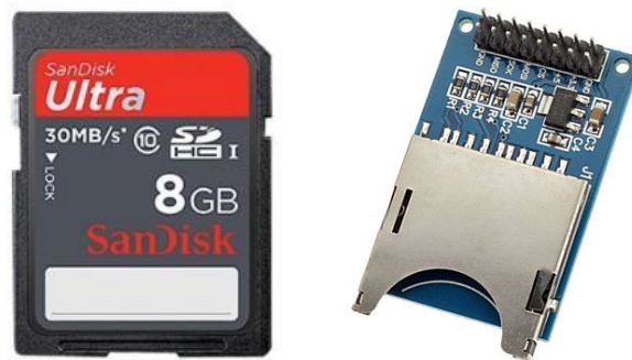
Il·lustració 13: Tots els components necessaris per a la construcció d'un Datalogger per Arduino: la targeta SD de 8 GB a l'esquerra de la imatge i el mòdul SD Socket a la dreta, on es pot apreciar la ranura de color platejat on s'introdueix la targeta SD. (Font: https://www.sandisk.es/content ).
