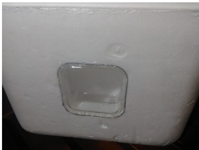
Il·lustració 34: Caixa de porexpan amb el forat per la càmera tapat amb una làmina gruixuda de plàstic que l'aïlla de l'exterior. (Elaboració pròpia).
