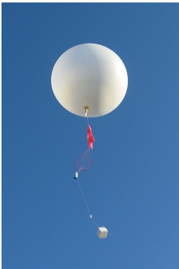
Il·lustració 3: Fotografia d'una sonda estratosfèrica en ple ascens. Es pot observar el globus circular a dalt de tot de la imatge, juntament amb el paracaigudes de color vermell i la caixa on hi ha tots els sensors i sistemes de comunicació, al peu de la imatge i de color blanc. (Font: http://radiosondemuseum.org ).
